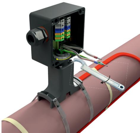
**Шаг 13:** Через кабельный ввод введите силовой кабель на достаточную длину для выполнения подключения к клеммным соединителям.
