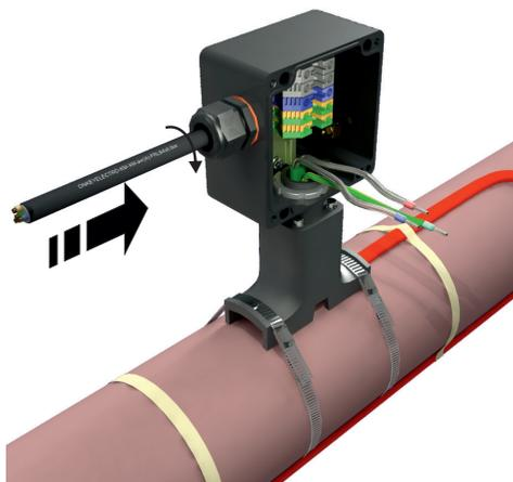
**Шаг 14:** Подключите силовую кабель и провод заземления к клеммным соединителям. Выполните подключение нагревательных секций в соответствии со схемой.
