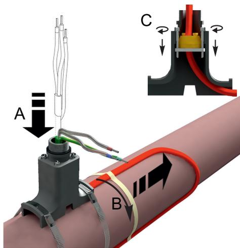
**Шаг 10:** Установите кабельные вводы и заглушки из комплекта поставки соединительной коробки в отверстия в соответствии с моделью коробки и ее назначением. Внутри кабельных вводов установите уплотнения и затяните гайки кабельных вводов.
