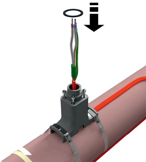
**Шаг 9:** Излишек кабеля протяните обратно через опору (A) в сторону обогреваемого объекта. Закрепите излишек кабеля с помощью адгезивной крепежной ленты FT/НТМ (B). Затяните крепежные винты на опоре (C) с усилием, достаточным для выполнения герметизации нагревательной секции в опоре.
