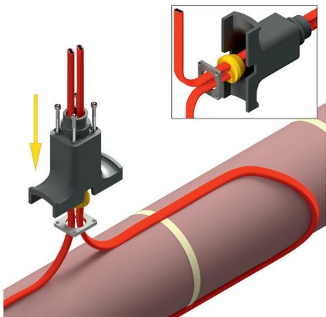
**3 нагревательных кабеля:** заведите 3 нагревательных кабеля в пластину УВК.0012 и в опору. Заглушки при этом не используются. Установите соединительную коробку в соответствии Шагами 7–17 вышеизложенной инструкции по монтажу.
