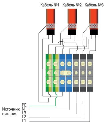
**Подключение трёх нагревательных кабелей к источнику питания с одновременным выполнением ответвления силового кабеля к дополнительной нагрузке.**
