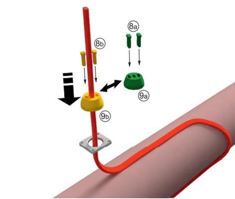
**Шаг 5:** Наденьте на нагревательные секции опору УВК.01.01 (Поз. 5) и протяните кабель вверх. Вставьте уплотнение в опору.
