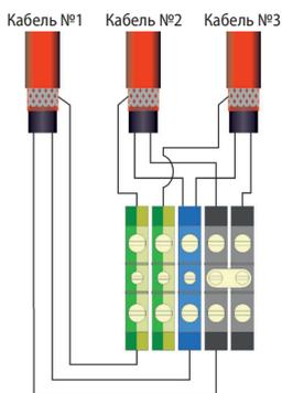
**Внимание:** при использовании данного способа подключения убедитесь, что общая длина 3-х нагревательных кабелей не превышает максимальную длину нагревательной секции (суммарную длину секций одной марки, подключаемых параллельно), зависящую от типа выбранного нагревательного кабеля и автоматического выключателя.
