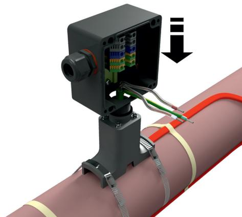
**Шаг 12:** Зафиксируйте корпус коробки на опоре с помощью гайки ДЭСТУ.0002 (поз. 7). Гайка закручивается с помощью ключа для круглых шлицевых гаек под внешний диаметр гайки от 45 мм до 52 мм (ключ в комплект поставки не входит).
