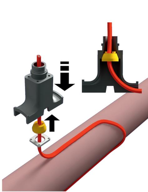
**Шаг 6:** Вставьте в опору сверху четыре винта крепежа уплотнения (размер под ключ 4 мм) с шайбами и наживите их в пластину с помощью ключа-шестигранника (в комплект поставки не входит). Не затягивайте винты до конца. Это нужно будет сделать на заключительном этапе монтажа.
